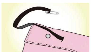
ひもの端に安全ピンをつけて、通し口に入れます。外から安全ピンを触って、もう片方の通し口に向かって進めていけば、ひもを通すことができます。
